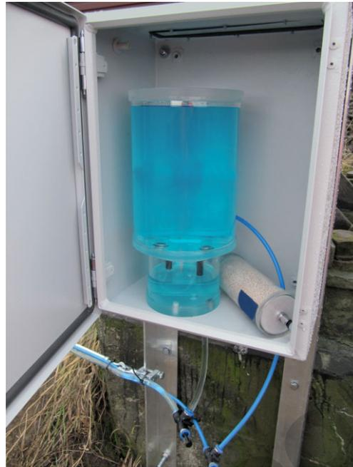
**Bild 12** Ausgleichsgefäß elektronische Schlauchwaage
