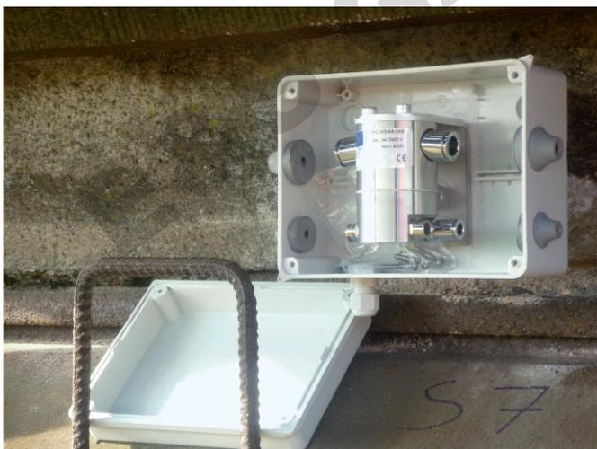
**Bild 11** Präzisionsschlauchwaage während der Montage
