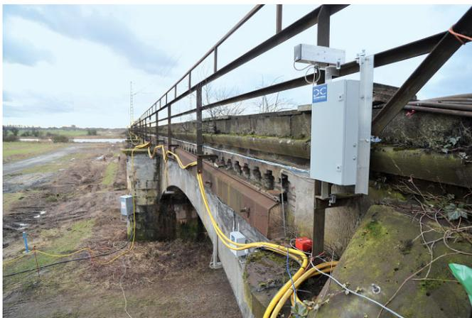
**Bild 10** Laserdistanzmesser am Brückengeländer
